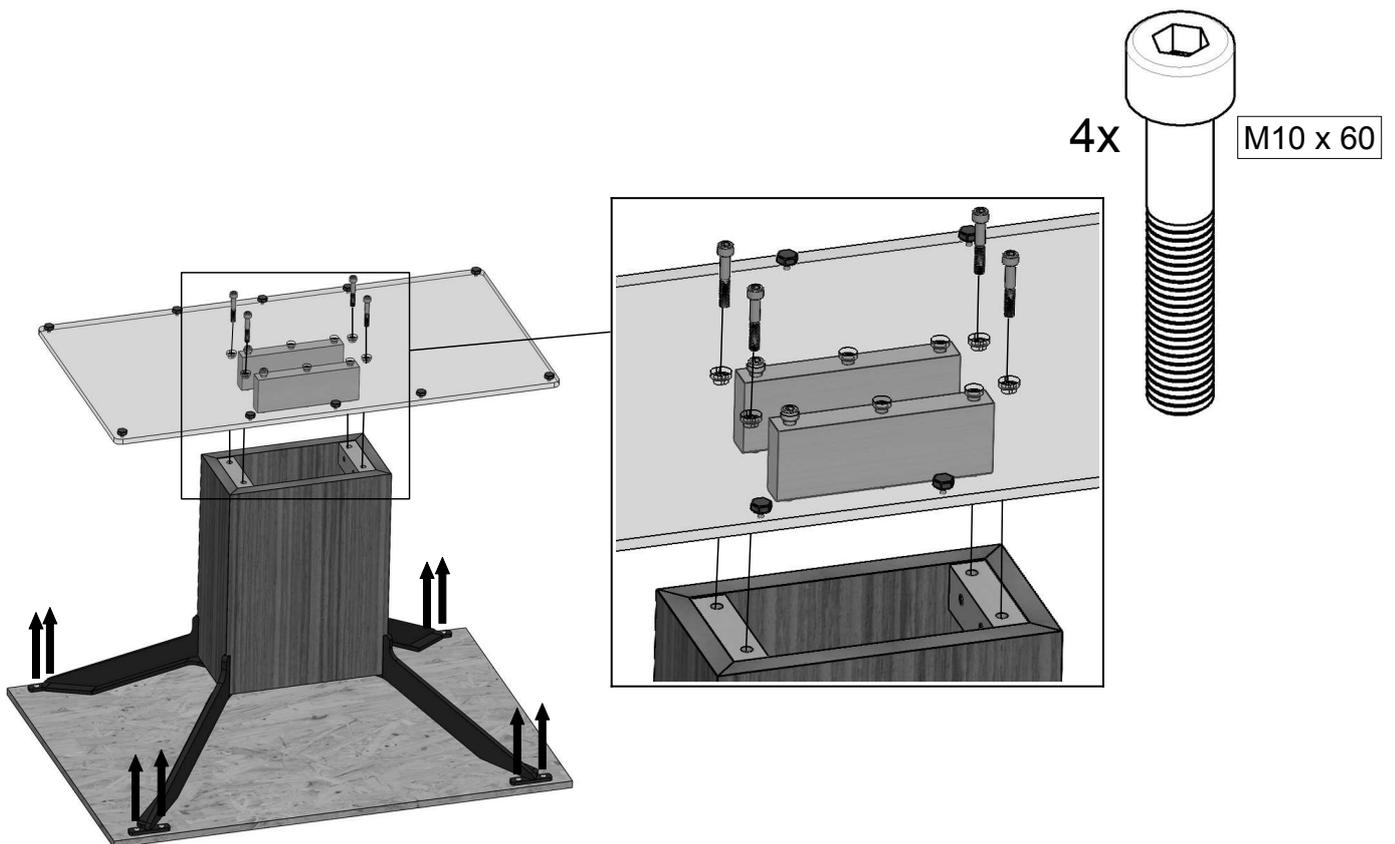
6. Die Bodenplatte mit der Holzsäule verschrauben. Die zweite Spanplatte abschrauben und entfernen.
