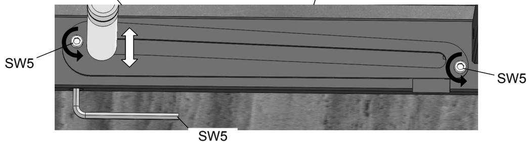
12. ... die beiden äußeren Inbusschrauben etwas lösen. Nun durch Drehen der inneren Inbusschraube die Höhe der Drehstange einstellen. Anschließend die beiden Inbusschrauben wieder festziehen.
