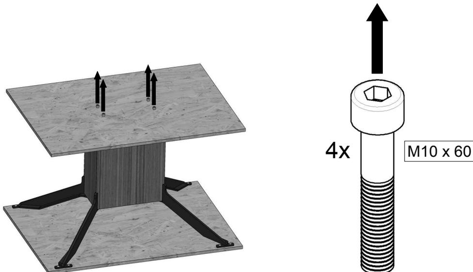
4. Vier Schrauben ausdrehen und aufbewahren. Die Spanplatte entfernen.
