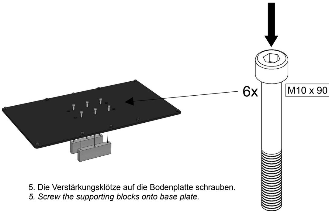
5. Die Verstärklötze auf die Bodenplatte schrauben.
