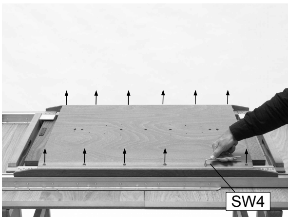
3. Die Schrauben des Plattenträgers mit einem Inbusschlüssel lösen. 3. Loosen the screws of the top holder with a hex-wrench
