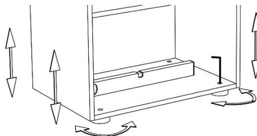
Frontteile (Schubkästen, Türen) ausbauen. Möbelgleiter durch Drehen im Uhrzeigersinn auf den Nullpunkt stellen, horizontal und vertikal ausrichten. Korrekturen von innen mittels Inbusschlüssel oder von außen mit Hand vornehmen. Löcher mit Abdeckkappen schließen.
